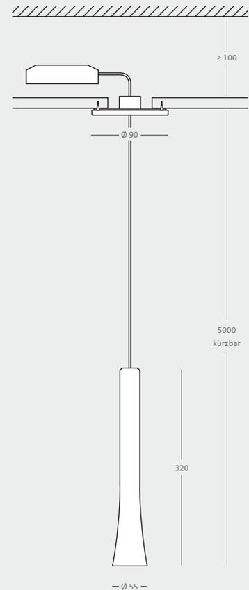
Pro Pendelleuchte wird je eine Deckenarmatur und je ein Netzteil benötigt.
