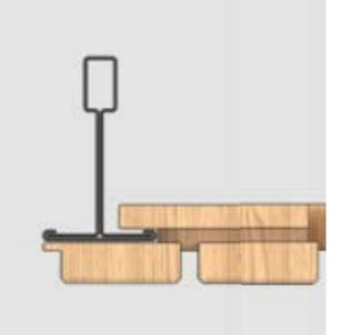
Natur Acoustic ist ein abgehängtes Deckensystem aus MDF-Platten und verdeckten Metallprofilen. Alle Platten können montiert und demontiert werden, wobei die Stabilität des Systems in jeder Situation erhalten bleibt. Die Bearbeitung der Platte erhöht die Schallabsorption und sorgt für mehr Komfort im Raum.
