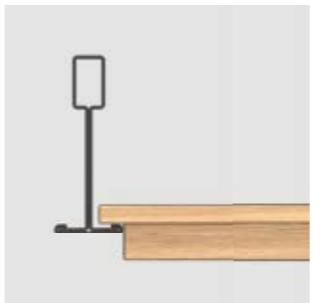
Natur T-Grid 15 verwendet 15 mm breite Profile für ein 600x600 mm großes Raster aus 12 mm dicken MDF-Platten mit einer Größe von 584x584 mm, die in 8 mm Abstand vom Profil aufgehängt sind.
