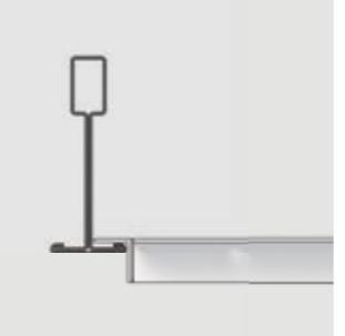
T-Grid 15 verwendet 15 mm breite Profile für ein 600x600 mm großes Raster aus Platten mit einer Größe von 584x584 mm, die in 8 mm Abstand vom Profil aufgehängt sind.
