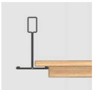
Natur T-Grid 24 verwendet 24 mm breite Profile für ein 600x600 mm großes Raster aus 12 mm dicken MDF-Platten mit einer Größe von 574x574 mm, die in 8 mm Abstand vom Profil aufgehängt sind.
