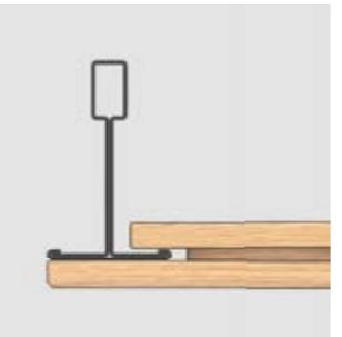
Natur Cover 1200 besteht aus verzinkten Stahlprofilen auf zwei Ebenen und 12 mm dicken MDF-Platten, die das gesamte Profilsystem verdecken und ein 1.200x300 mm großes Raster bilden.
