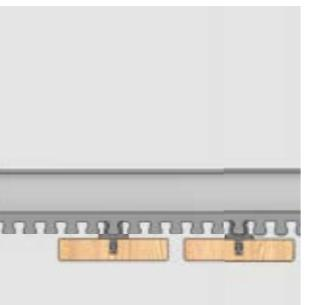
Natur Flat 80 verwendet MDF-Lamellen mit einer maximalen Länge von 2.400 mm, die von stranggepressten Aluminiumprofilen und einem 3.000 mm langen Noppenbefestigungssystem aus feuerfestem Kunststoff gehalten werden. Die Kunststoffnuppen und die Lamellenbreite von 80 mm ermöglichen unterschiedliche Abstände und Modulgrößen.
