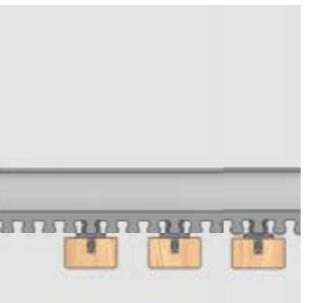
Natur Flat 40 verwendet MDF-Lamellen mit einer maximalen Länge von 2.400 mm, die von stranggepressten Aluminiumprofilen und einem 3.000 mm langen Noppenbefestigungssystem aus feuerfestem Kunststoff gehalten werden. Die Kunststoffnuppen und die Lamellenbreite von 38 mm ermöglichen unterschiedliche Abstände und Modulgrößen.
