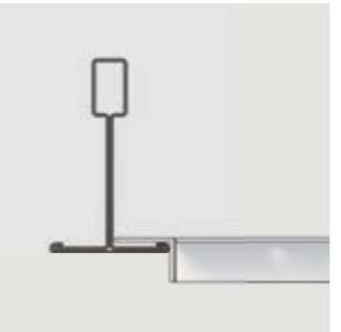
T-Grid 24 verwendet 24 mm breite Profile für ein 600x600 mm großes Raster aus Platten mit einer Größe von 574x574 mm, die in 8 mm Abstand vom Profil aufgehängt sind.
