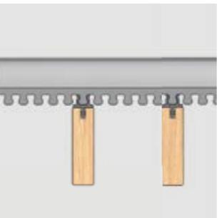
Natur Vertical 80 verwendet MDF-Lamellen mit einer maximalen Länge von 2.400 mm, die von stranggepressten Aluminiumprofilen und einem 3.000 mm langen Noppenbefestigungssystem aus feuerfestem Kunststoff gehalten werden. Die Kunststoffnoppen und die Lamellenhöhe von 80 mm sowie die Lamellenbreite von 22 mm ermöglichen unterschiedliche Abstände und Modulgrößen.
